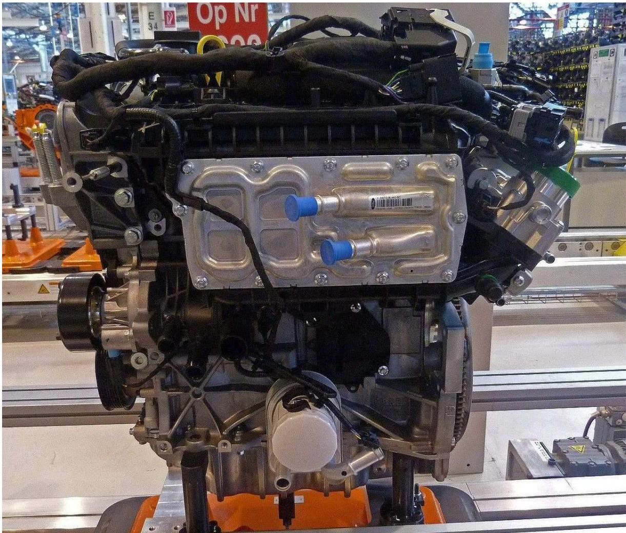
**Der neue 1.5-EcoBoost-Vierzylinder verfügt über einen Alu-Motorblock und ist das erste Ford-Triebwerk, das eine computergesteuerte Kupplung am Riemenantrieb der Wasserpumpe integriert, um die Warmlaufzeit zu reduzieren. Zusätzlich hat es einen wassergekühlten Ladeluftkühler für ein insgesamt effizienteres Motor-Wärmemanagement (Foto: Ford)**
